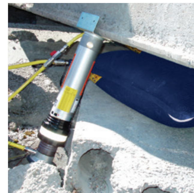
Cilindro autoblocante utilizado como apoio a almofada de elevação.
