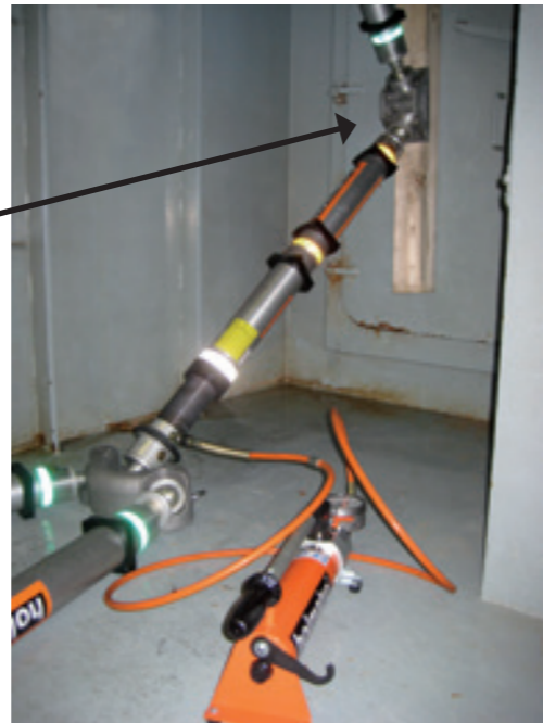
Um suporte de três cabeças giratórias e um suporte em duas direcções utilizado para linhas de escoramento em várias direcções
