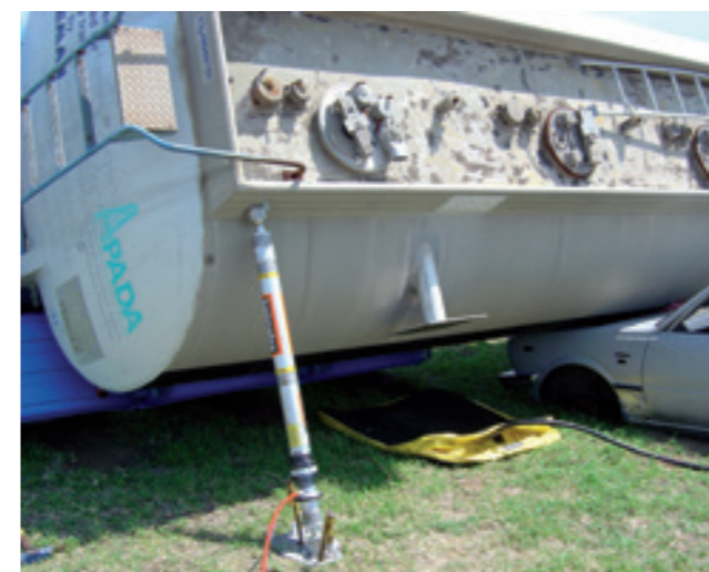
Cilindro pneumático autoblocante utilizado como escoramento de seguimento em operações de elevação de um veículo pesado.
