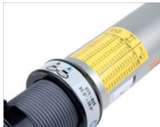
Etiqueta amarela num cilindro indicando a relação carga – comprimento.
