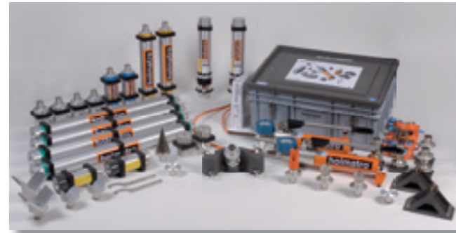
Conjunto de controlo de danos navais.
