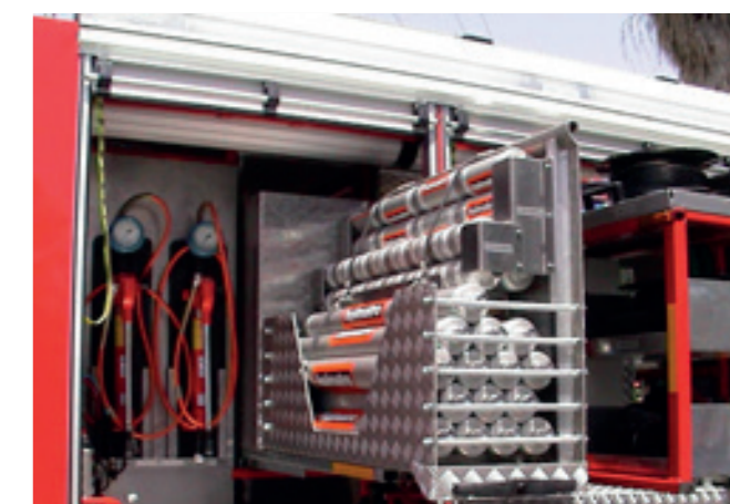
PowerShore de Holmatro num camião de resgate.
