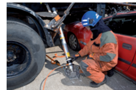
Estabilização de veículo pesado com cilindro hidráulico com contra-porca.
