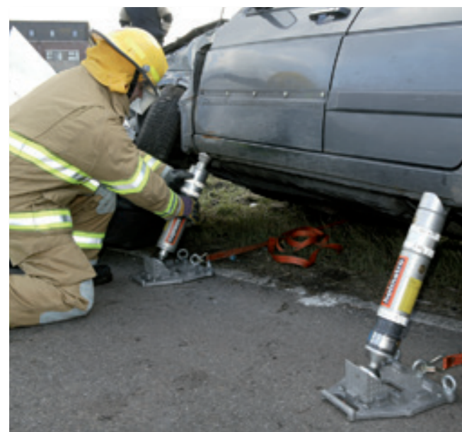
Estabilização de veículo com cilindros manuais contra-porca.
