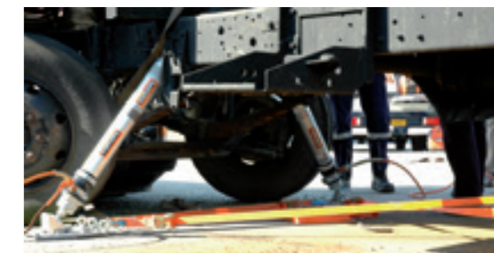
Estabilização de veículo pesado com cilindro hidráulico com contra-porca.
