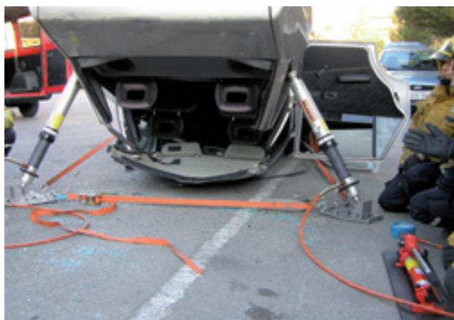
Estabilização de veículo ligeiro com cilindros hidráulicos com contra-porca.
