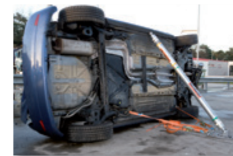
Placa base, extensões e cabeças utilizadas na estabilização de um veículo ligeiro.
