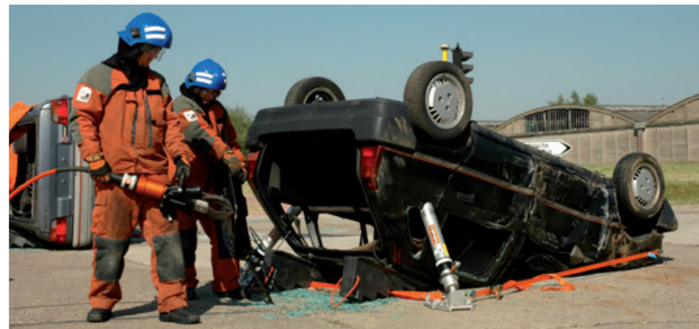
Dois cilindros hidráulicos utilizados na estabilização de um veículo ligeiro e, se necessário, para uma elevação controlada.
