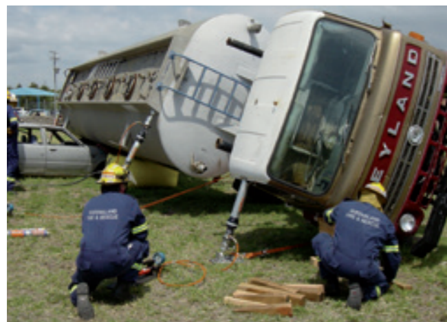
Cilindro hidráulico autoblocante escorando e elevando um veículo pesado.
