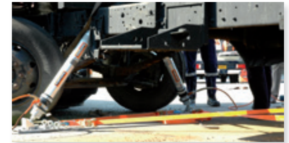
Stabilisatie van een zwaar voertuig met hydraulische borgmoerstut.
