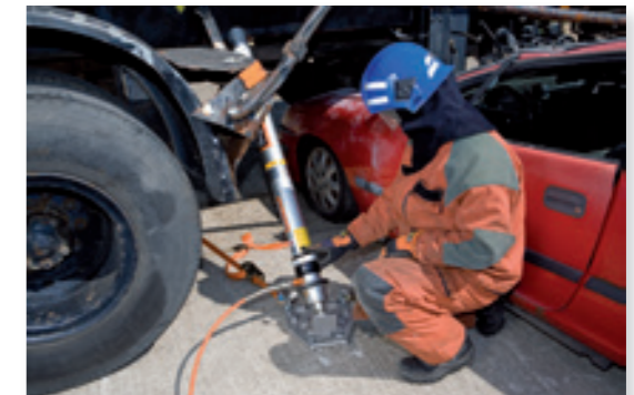
Stabilisatie van een zwaar voertuig met hydraulische borgmoerstut.
