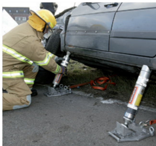
Voertuigstabilisatie met handbediende borgmoerstutten.
