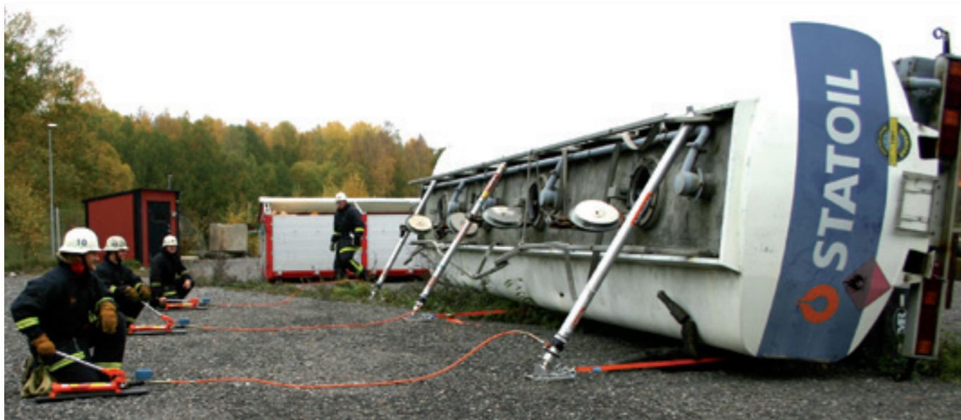
Het stutten en heffen van een tankwagen met een hydraulisch PowerShore systeem.
