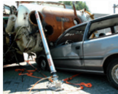
Stabilisatie van een zwaar voertuig met hydraulische borgmoerstutten.
