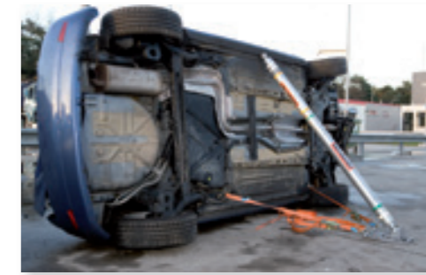
Verlengpijpen, koppen en grondplaat gebruikt voor stabilisatie van een personenauto.
