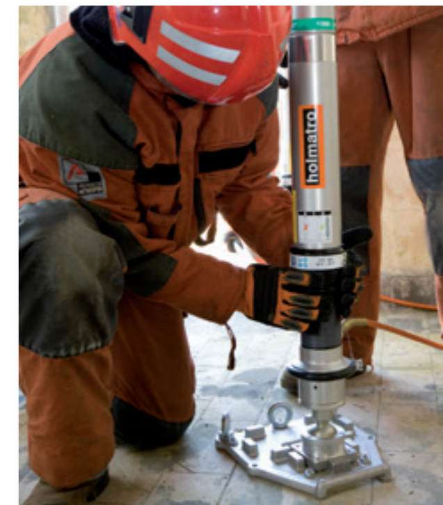
Pneumatische borgmoerstut gebruikt als handbediende stut in een ingestort gebouw.
