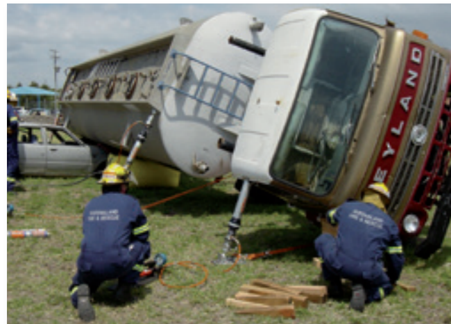
Het stabiliseren en heffen van een zwaar voertuig met hydraulische Auto-lock stutten.
