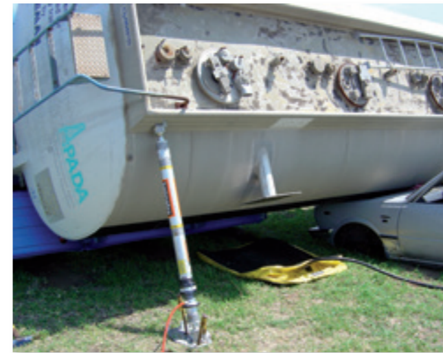
Pneumatische Auto-lock stutten gebruikt voor follow-up shoring bij het heffen van een zwaar voertuig.
