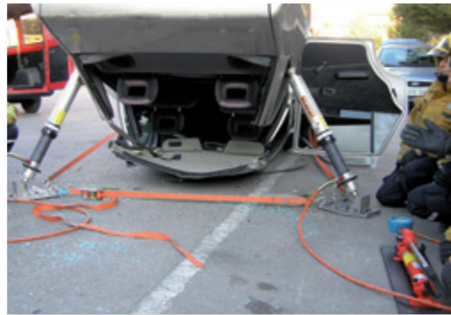
Stabilisatie van een personenauto met hydraulische borgmoerstutten.
