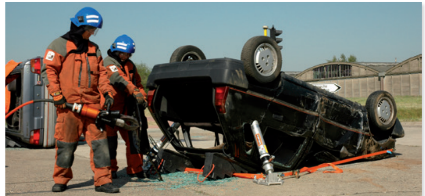
Twee hydraulische stutten gebruikt voor het stabiliseren en, indien nodig, gecontroleerd heffen van een personenauto.
